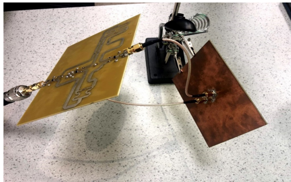
Figura 9 – Montaje de medición de la antena reconfigurable.
