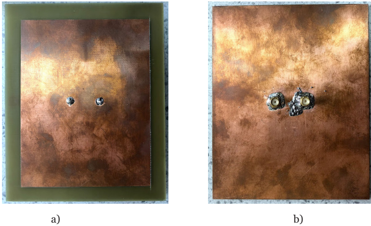
Figura 6 – Fotografía de la antena parche construida, a) vista frontal, b) vista posterior.
