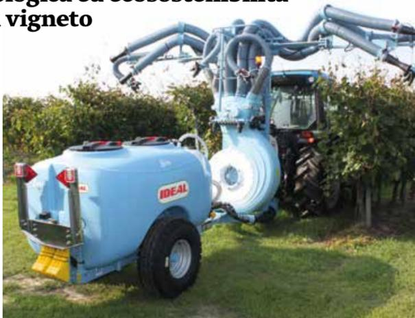
a facilitare l'operatività, minimizzando gli effetti ambientali. Ne sono la dimostrazione il nebulizzatore semi-portato Bora, concepito per lavorare su più filari contemporaneamente in zone collinari grazie alla speciale configurazione con ventilatore portato ai tre punti del trattore e cisterna trainata da un timone snodato e il nebulizzatore Phantom, specifico per lavorare in basso volume in vigneti a tendone. Ancora, gli
