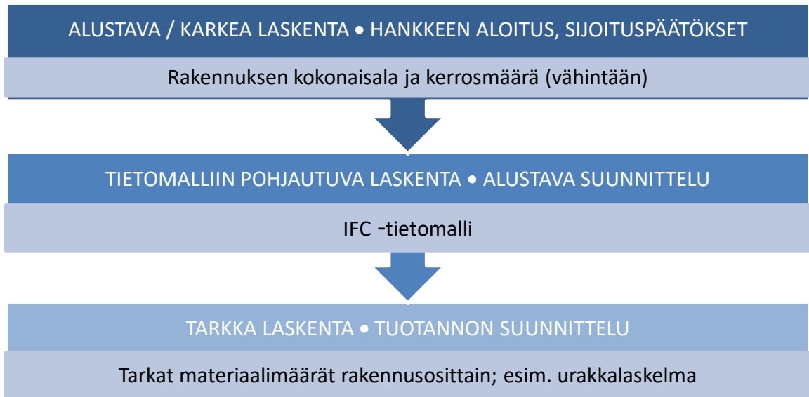
Kuva 5: Laskentamenetelmien käyttö rakennushankkeen eri vaiheissa ja laskennan vaatimat lähtötiedot. Kaikissa laskennoissa tarvitaan lisäksi tiedot energiankulutuksesta, arviointijakson pituudesta ja lämmitetystä nettoalasta.
