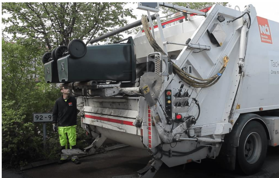
Mynd 6 Hirðubíll í Gautaborg vigtar ílát undir úrgang (Botek, 2021).
