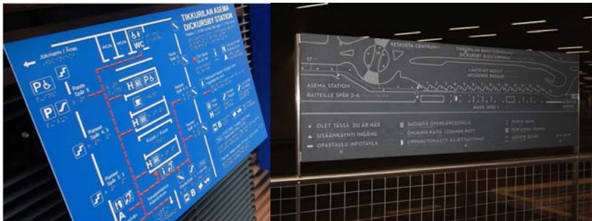
Kuva 4 a ja b. Tikkurilan matkakeskuksessa olevat kohokartat testauksen lähtötilanteessa. Vasemmalla oleva kartta on akryylistä valmistettu, asemasillalla oleva kohokartta ja oikealla oleva on Durat-materiaalista jyrsimällä toteutettu kohokartta bussiterminalissa ja asemarakennuksen eteläisellä sisäänkäynnillä.
