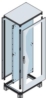
Estructura en kit serie IS2 dim. 2000 x 800 x 600 mm (2105 x 794 x 610 mm. HxAxP exteriores) IP65 con puerta ciega, placa de montaje y zócalo H = 100 mm (tapas excluídas).
