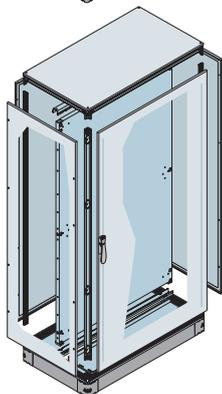
Estructura en kit serie IS2 dim. 2000 x 1000 x 600 mm (2105 x 1010 x 610 mm. HxAxP exteriores) IP65 con puerta ciega, placa de montaje optimizada, paneles laterales, tapas entrada cables correderas y zócalo H = 100 mm (tapas incluídas).
