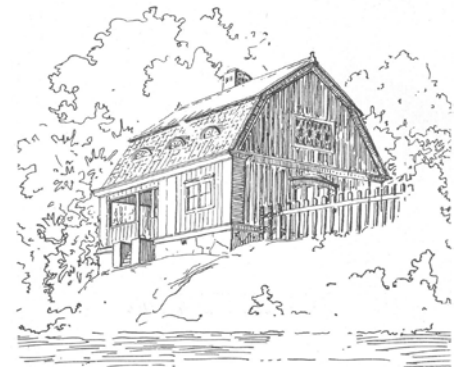
Arkkitehti Ivar Thomén voittanut kilpailuehdotus Oman kodin piirustuksia kilpailuun 1913. Hirsi- ja lauterakenteinen, pärekattoinen, mansardikattoinen rakennus, jossa sisään vedetty kuisti.
